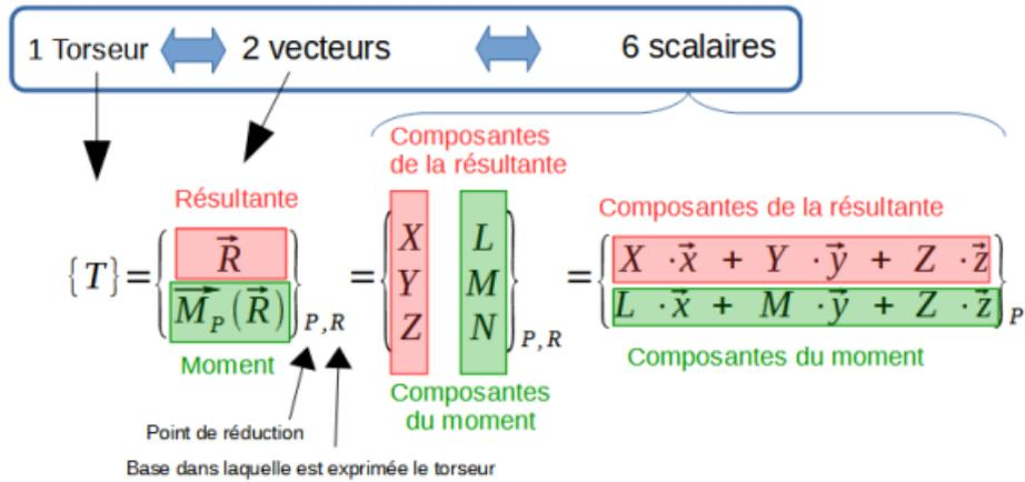
Figure 3: Expression d'un torseur d'action mécanique
