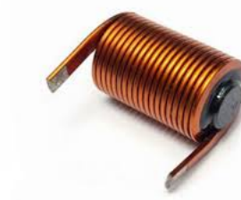
Figure 12: Inductance utilisée en électronique destinée à lisser le courant et/ou à stocker et déstocker de l'énergie électrique
