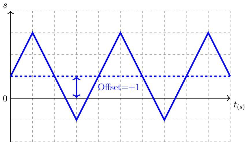
Figure 14: Signal triangulaire avec Offset de +1
