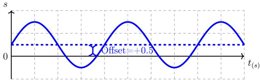
Figure 15: Signal sinusoïdal avec Offset de  $+0.5$
