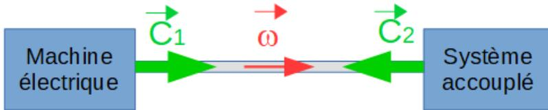
La machine électrique impose un couple C1 de 40 N.m
