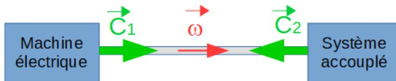
Le couple C1 est imposé par la machine électrique et le couple C2 par le système accouplé.
