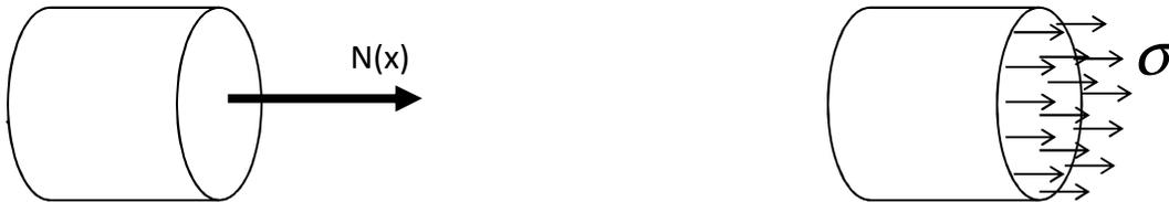
On appelle **contrainte normale  $\sigma$**  (sigma) la **répartition uniforme** de l'effort normal dans une section perpendiculaire à la ligne moyenne de la poutre.
